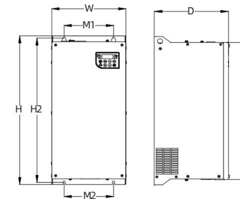
FE、FF结构及安装尺寸示意图
