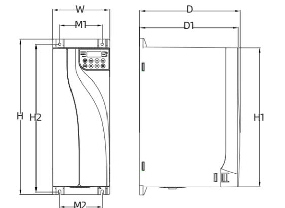
FD结构及安装尺寸示意图
