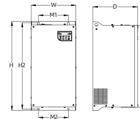
FE、FF结构及安装尺寸示意图
