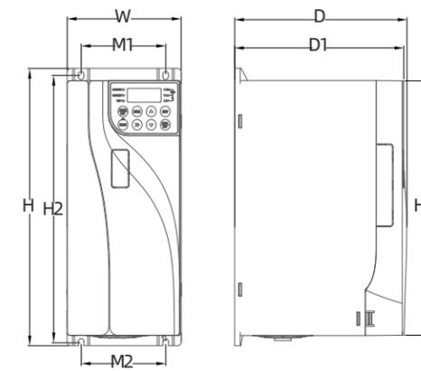
FC结构及安装尺寸示意图
