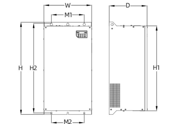
FG结构及安装尺寸示意图
