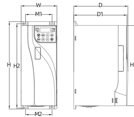
FC结构及安装尺寸示意图
