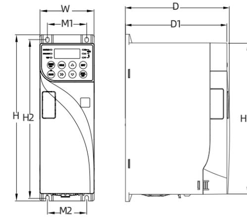
FA结构及安装尺寸示意图
