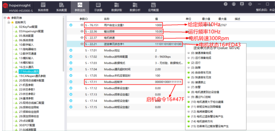
图 5.2 变频器运行状态监控
